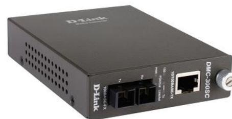
Эти медиаконвертеры преобразуют сигнал из стандарта 10BASE-T/100BASE-TX Fast Ethernet на витой паре в сигнал стандарта 100BASE-FX Fast Ethernet по многомодовому оптическому кабелю. Максимальная длина оптического кабеля: 2 км. Устройство оснащено 1 портом RJ-45 для витой пары и 1 оптическим портом.
