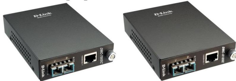
Медиаконвертер DMC-700SC: преобразует сигнал из стандарта 1000BASE-T Gigabit Ethernet на витой паре в сигнал стандарта 1000BASE-SX Gigabit Ethernet по многомодовому оптическому кабелю. Максимальная длина оптического кабеля: 550 м. Устройство оснащено 1 портом RJ-45 для витой пары и 1 оптическим портом с разъемом SC.
