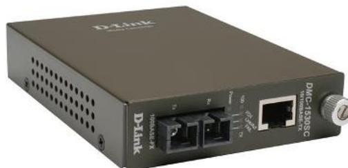
Данный медиаконвертер поддерживает интеллектуальные функции, такие как LLCF, LLR, механизм store-and-forward, управление потоком по стандарту 802.3x и метод «back-pressure». Медиаконвертер преобразует сигнал из стандарта 10BASE-T /100BASE-TX Fast Ethernet на витой паре в сигнал стандарта 100BASE-FX Fast Ethernet по одномодовому оптоволокну. Максимальная длина оптического кабеля – 30км. Устройство оснащено 1 портом RJ-45 для витой пары и 1 оптическим портом с разъемом SC.
