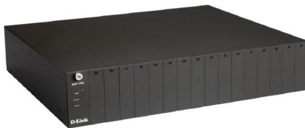
Шасси позволяет устанавливать сразу несколько медиаконвертеров в стойку вместе с сетевым оборудованием, для которого необходимо преобразовать среду передачи данных. Использование шасси обеспечивает экономию пространства и позволяет оптимизировать размещение кабеля. В комплект поставки шасси входит блок питания. Также можно установить резервный блок питания.
